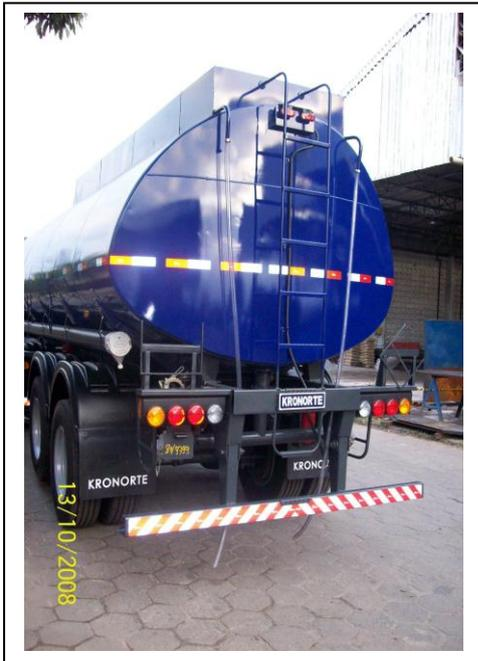
**Figura 18** - Calota do tanque de carga.
