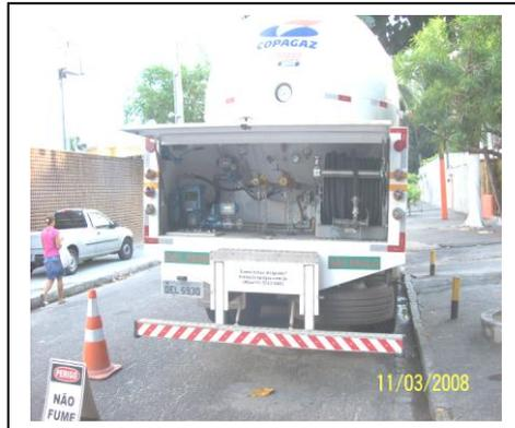
**Figura 35:** Caminhões do tipo Auto Taque para transporte de GLP (Traseira).
