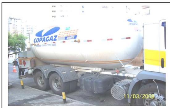
**Figura 39:** Caminhões do tipo Auto Tanque para transporte de GLP (visão lateral).
