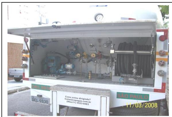
**Figura 37:** Caminhões do tipo Auto Tanque para transporte de GLP (Traseira - visão aproximada).
