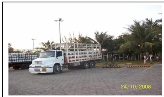
**Figura 32** – Caminhões do tipo Gaiola para transporte de GLP (Visão lateral).
