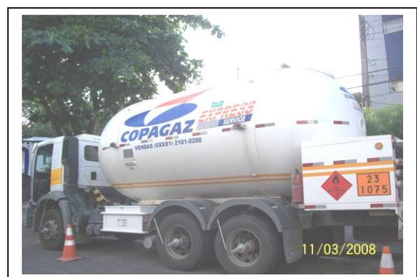
**Figura 38:** Caminhões do tipo Auto Tanque para transporte de GLP (visão lateral).
