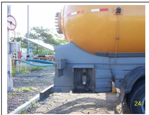
**Figura 27** – Válvula de bloqueio lateral com volante.
