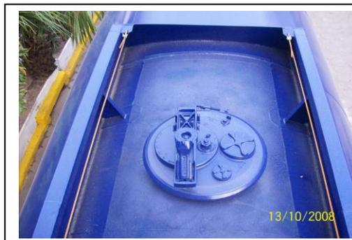
**Figura 20** - Tampa de inspeção e carga/
