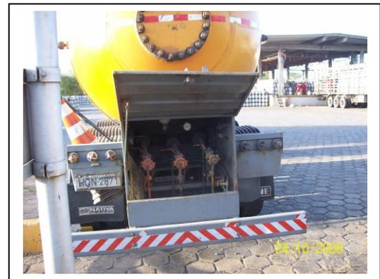
**Figura 26** – Tubulações de GLP na calota do tanque de carga.
