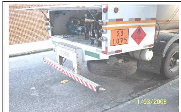
**Figura 40 –** Caminhões do tipo Auto Tanque para transporte de GLP (traseira).
