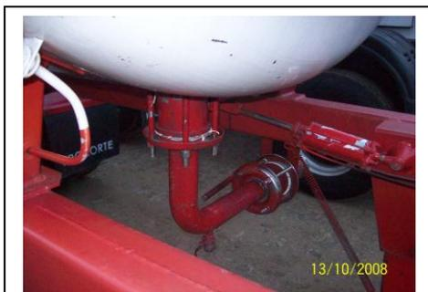
**Figura 23** – Válvulas de fundo e de dreno.
