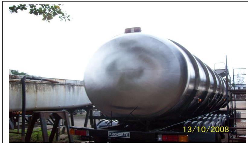
**Figura 21** – Calota do tanque de carga.
