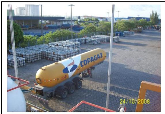
**Figura 25** –Carreta tanque com 42.000L de volume, com cerca de 20 ton de GLP.
