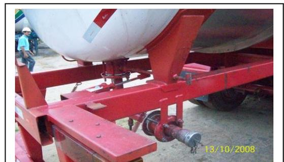
**Figura 24** – Válvula de descarga.
