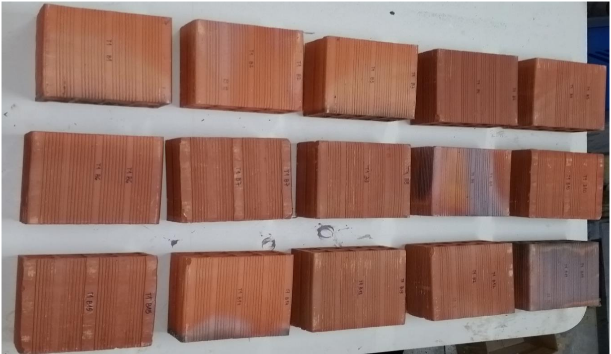
Figura 19 – Marcação dos blocos de referência (tipo 1)
