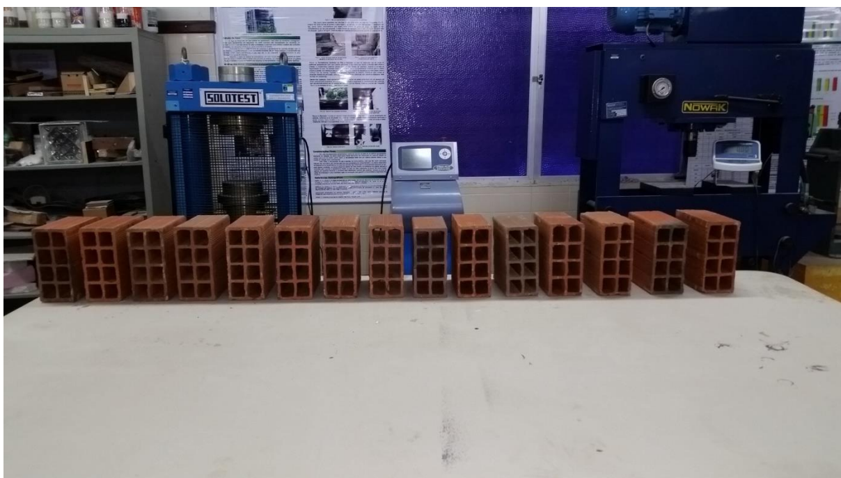
Figura 18 – Medição das principais dimensões dos blocos
