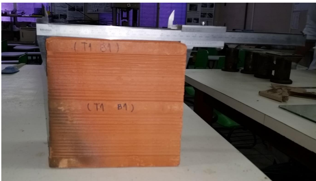
Figura 18 – Medição das principais dimensões dos blocos
