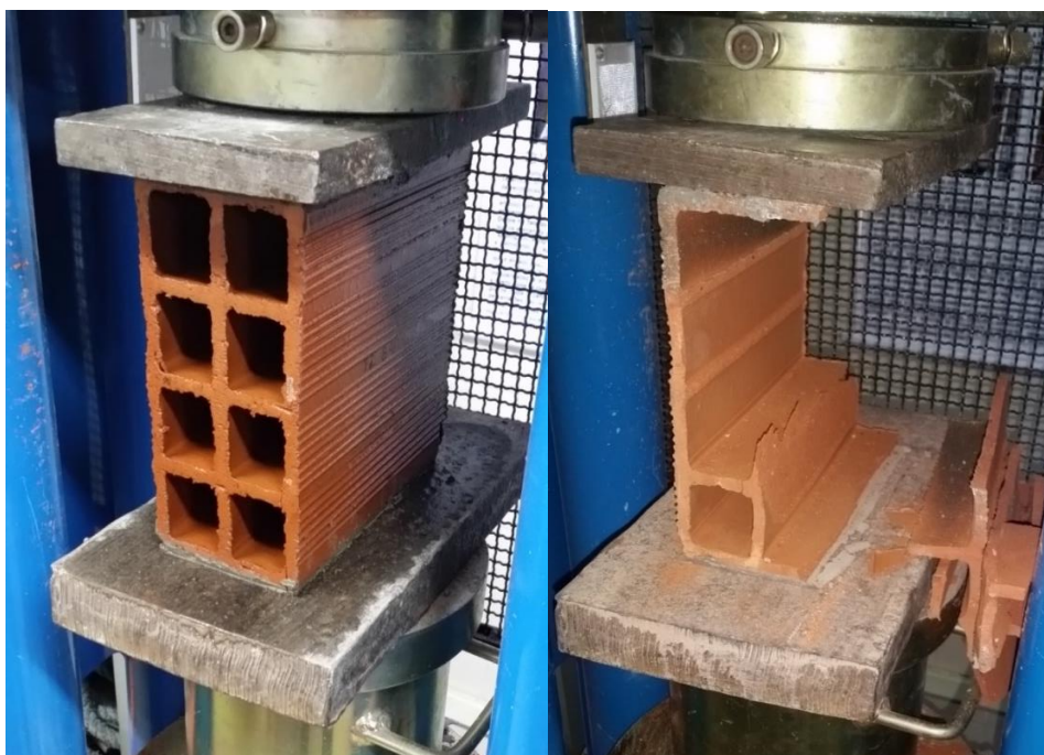
Figuras 35 e 36 – Ensaio de Resistência à Compressão (antes e depois) do bloco 15
